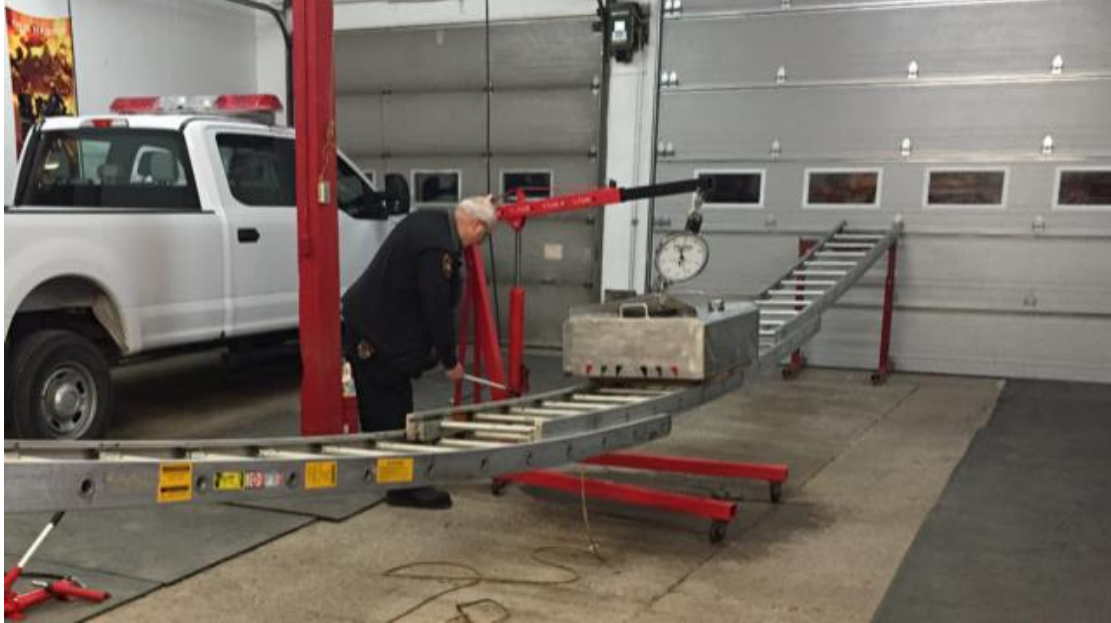
Notre responsable des services techniques lors d'un test d'échelle portative
